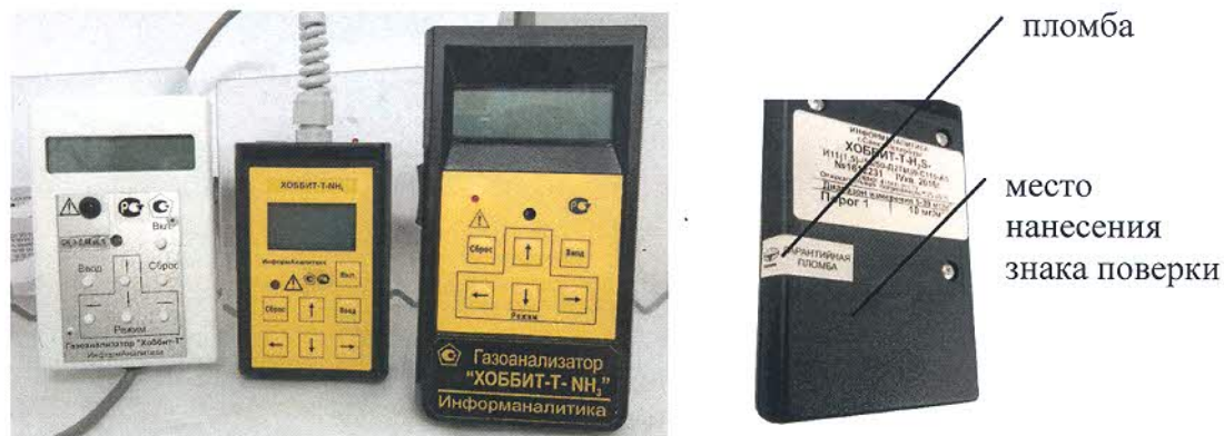
Рисунок 3 – Общий вид блоков индикации переносных газоанализаторов, схема пломбировки от несанкционированного доступа, место нанесения знака поверки
