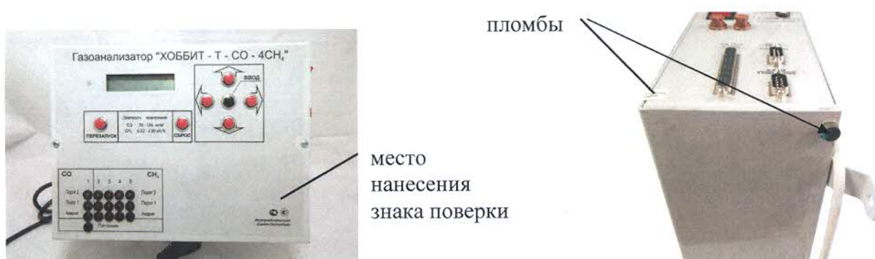
Рисунок 4 – Общий вид блока индикации стационарных газоанализаторов, схема пломбировки от несанкционированного доступа, место нанесения знака поверки
