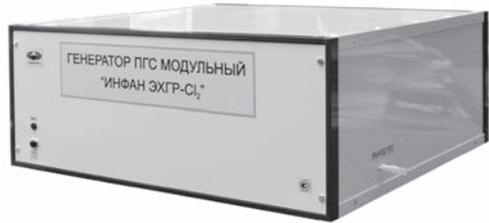
Использование генераторов «ИНФАН» позволяет расширить номенклатуру применяемых ПГС, в том числе за счёт добавления возможности работы с агрессивными газами, такими как  $\text{Cl}_2$ ,  $\text{HCl}$ ,  $\text{HF}$ ,  $\text{HCN}$ . Необходимость приготовления смесей непосредственно в месте проведения работ вызвана тем, что ПГС на основе агрессивных газов взаимодействуют с материалом стенок сосуда и не могут сохранять метрологические характеристики неизменными в условиях длительного хранения.
