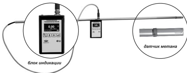
Оснащён ярким цифровым OLED дисплеем, который индицирует текущие результаты измерения, время, дату и уровень заряда аккумуляторной батареи.
